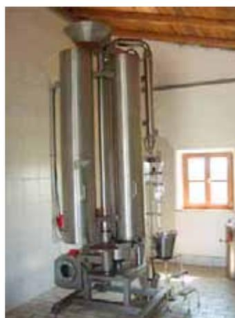
Dies wird erreicht durch die Ausführung der Destillationsblase als schlanken hohen Zylinder, wodurch eine Kaminwirkung entsteht. (Das genau definierte Verhältnis von Querschnitt und Höhe der Blase ist patentrechtlich geschützt!)
