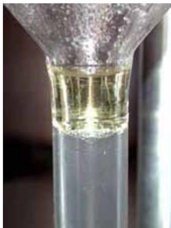
Die Kühler Temperatur wird geregelt und der jeweiligen Pflanzenart, bzw. der Viskosität des Öles angepasst. Wasser und Öl trennen sich bereits im Kühler und werden in einem Phasentrenngefäß aufgefangen.
